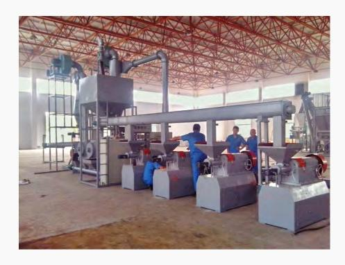
GTM橡胶磨粉机是一种在常温下,可将进料规格为15-25目(无钢丝和其它高硬度杂质)的橡胶颗粒,一次性研磨成40-60目的精细橡胶粉的专用设备。若进料规格为60-80目,则出料为80-120目的超精细橡胶粉。其研磨范围可根据用户对橡胶粉的粒度需求进行调节。
