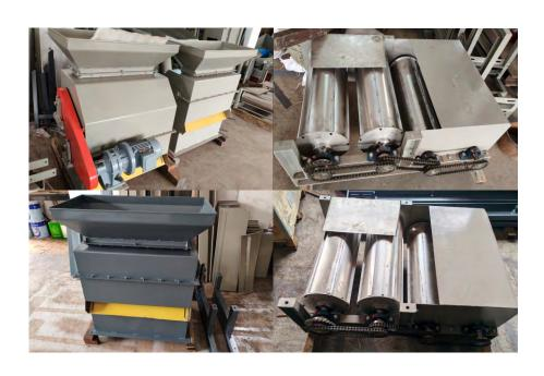
磁选机凭借其磁辊(或磁筒)所释放的强大磁场能量与磁感应强度,在橡胶轮胎破碎后的处理过程中,成为了分离钢丝与提纯橡胶的关键设备。
