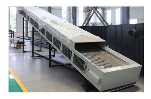
皮带输送机利用输送带的连续或间歇运动来输送100kg以下的松散物料,具有输送能力强、输送距离远、运送平稳可靠、拆装方便、易于维护、使用成本低等特点。
